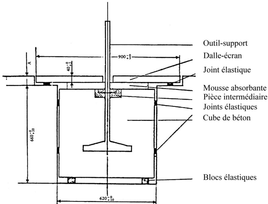
La valeur de A doit être telle que la plaque supérieure reposant sur le joint élastique J soit au ras du sol.
